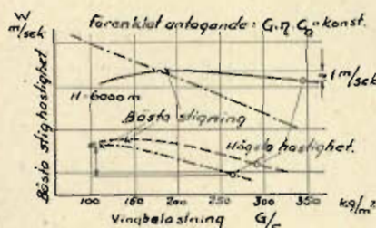
Fig. 2. Diagrammet, bästa stighastighet över vingbelastning, ger optimalvärden för stighastigheten ( x ) vid väsentligt mindre vingbelastning än vid projektutkastet till högsta hastighet, vilkas punkter ( o ) ha tagits ur fig. 1. Stighastighetsfallet, vilket kommer att uppträda vid hastighetsflygplan, är antytt med siffror (1 resp. 3,7 m/sek).
