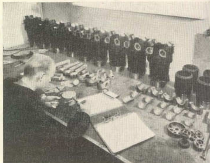
Mättningsprotokoll omfattande motordelarna ger kunden en god uppfattning om motorns återstående livslängd
