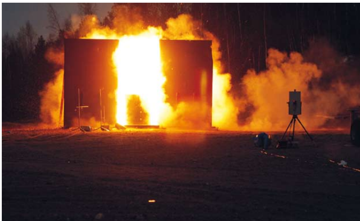
Ett verkansförsök mot ballistiska skydd vid T&E:s anläggning i Karlsborg. Mätutrustningen ger fakta om bland annat tryck, hastighet och penetration. Detta ger viktig information för kravställning av bättre skydd.
