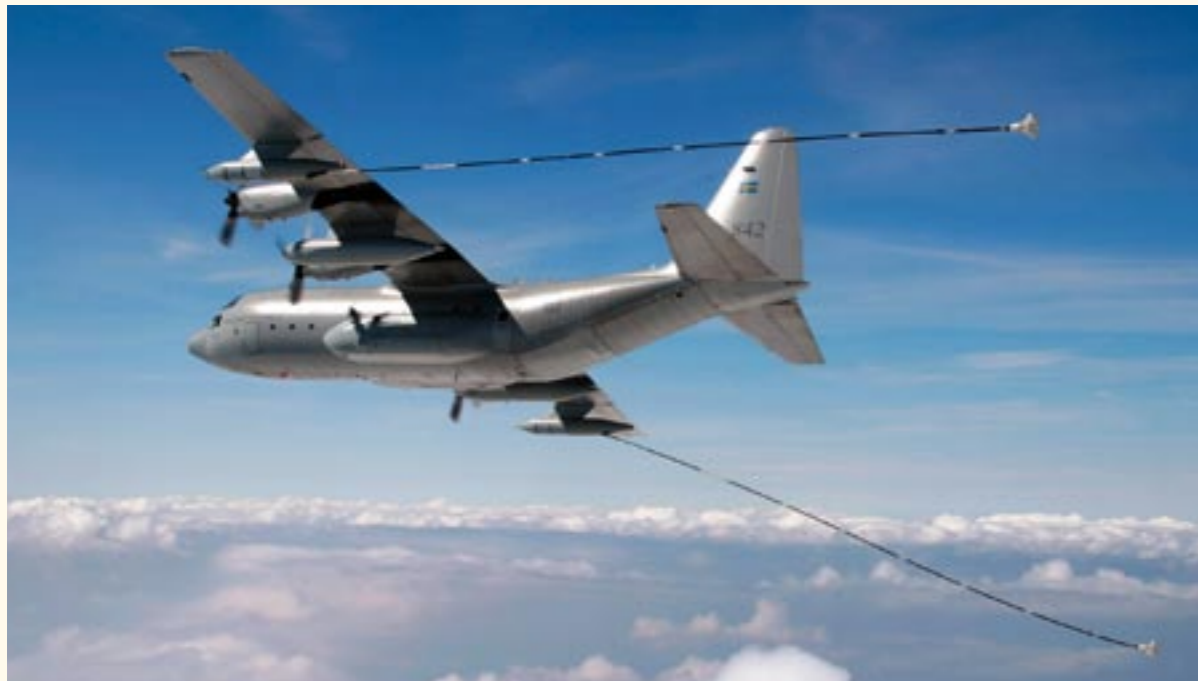
Hercules har nu genomgått flygtest med lufttankningspoddar.
