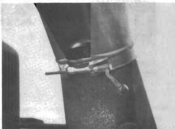
Snölastare m/F3, detalj av rännans nedre infästning i slungtratten
