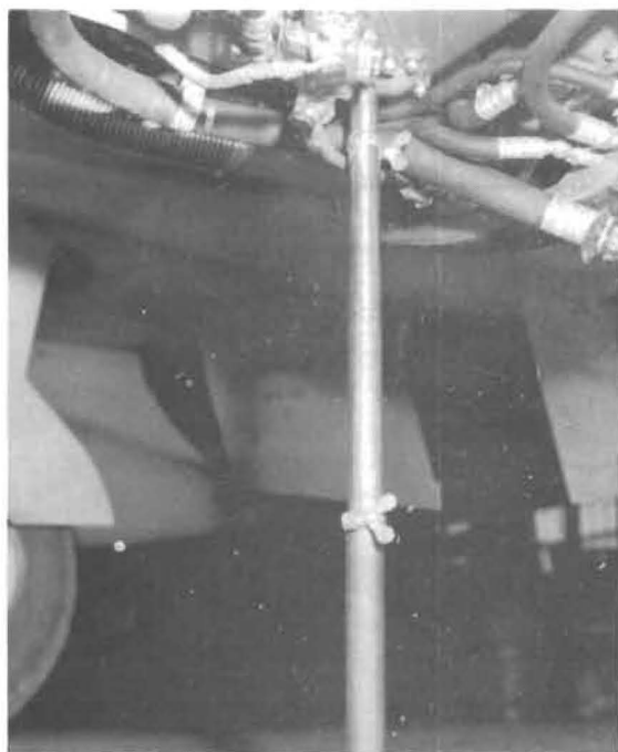
Bild 2 visar verktyget apert för nedmontering av filtret. Ge akt på att fpl står på domkrafter och att verktyget vilar mot en spillplåt på golvet.
