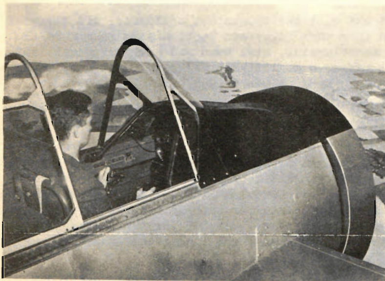
BILD 2 - LINKTRAINER MODELL "SK 16". EN TERRÄNGSKÄRM ÖKAR INTRYCKET AV "ÖPPEN" FLYGNING ("VFR", MED SIKT).
