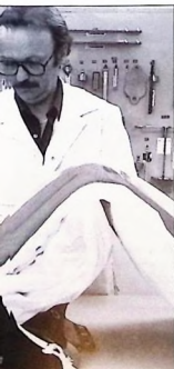
Susanne Nordkvist reparerar bromsfallskärmen till flygplan 35. Den utsätts för stor belastning vid uppbromsning efter landning. Det ställs stora krav på sömnaden för att klara dessa belastningar.
