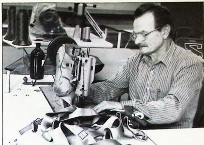
På bilden utför Bengt Karlsson en sömnadsdel på en fallskärmssele. Det är den mest kvalificerade i sömnadsvägar avdelningen här. Det är en mycket komplicerad sele, som ingår i fallskärmsystemet till flygplan 37, och den utsätts för stora belastningar vid räddning. Det är flera och grova sömmar på denna sele. Det är både tjockt att sy och svårt att komma åt.
