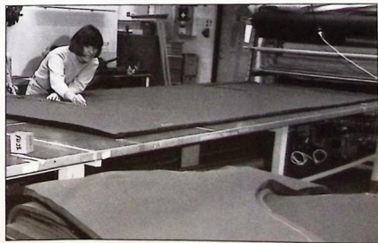
Susanne Nordkvist håller här på med tillskrivning av väv som ska bli skyddsöverdrag till flygplan 37:s flygplansstol.
