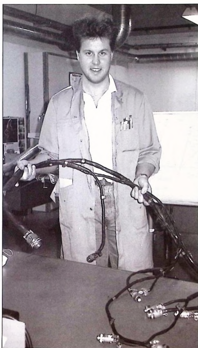
Fullständig översyn av alla enheter plus eventuella reparationer gör Patrik Götmar AV34 på den här kabelslen till Vigenmotor RM8.
