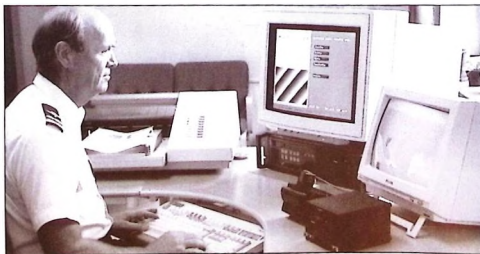
I markstation kan en utvärdering av flygpasset göras. Genom att vrida, flytta, förstora och förminska bilden kan man beräkna avstånd och närmandeshastighet till målet. Här är det Kurt Andersson som provar på utrustningen.
