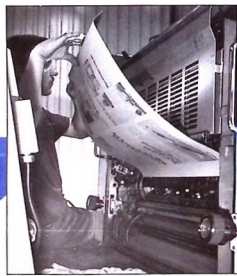
10. Mikael Roth arbetar i tryckeriet. Här sätter han in de färdiga plåtarna i tryckpressen. På bilden nedan (11) fylls papperet på.
