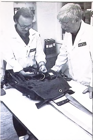
Kennet Robertsson och Bertil Carlsson laddar fallskärmsutlösaren till fallskärm 53B, vilken sitter i fpl 37. Laddningen av fallskärms krusdrivna apparater är ett av de viktigaste momenten i samband med packning och övervakas alltid av kontrollant. (ovan)
