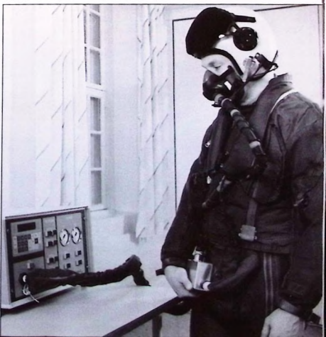
Tekniksektionen inom avdelning Tillverkning har medverkat vid framtagningen av flygstridsdräkten i form av lätt flyghjälm, syrgasmask och provutrustning. Dessutom har erforderlig mjukvara tagits fram och utbildning med berörd personal har skett. Fortsatt utveckling pågår samtidigt som ett C-skydd tas fram till piloten. (nedan)
