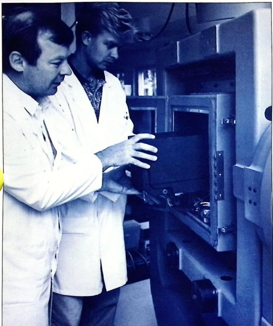
Håkan Palm och Magnus Wallén placerar lasergyroskop till JAS 39 Gripen i temperaturkammaren på det treaxliga vridbordet.
