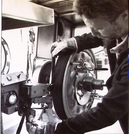
Regummering av bärhjul till stridsvagnar och stridsfordon utgör en viktig del av beläggningen för gummiverktaden. Det är en verksamhet som pågår i tio år och på bilden startar Lennart Holm uppbyggnad av slibarna på vårt senaste tillskott, med arbetsnamnet Bärhjul modell ny. Det är ett bärhjul som konstruerat av divisionens konstruktionsavdelning och tillverkas av avdelning Tillverkning. (ovan)
