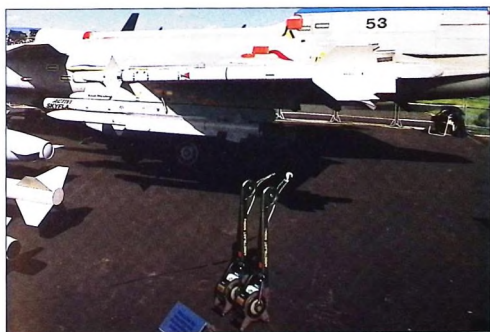
"Spinnspöt" tillverket av FFV Aerotech lyfter den yttre last som skall flötas på JAS 39 Gripen.
