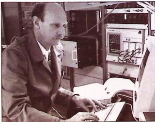
Vid JAS-testaren sköter Ronny Andersson från Målinmätning/Telekrig kontrollen under temperaturtest på delar till JAS radar PS-05.
