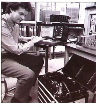
På bordet har Stefan Storm ställt prototypen till nytt yttre minne, YM, för flygplan AJIS och JA37. YM lagrar program och datafiler i flygplan-datorerna. På golvet står den föregångare till YM som skall ersättas.
