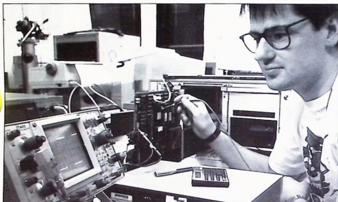
När "hårdvaran" tillverkas skall alla funktioner och programvara testas tillsammans med anpassad kringutrustning. Per Lius testar ett nytt tillverkat kretskort.
