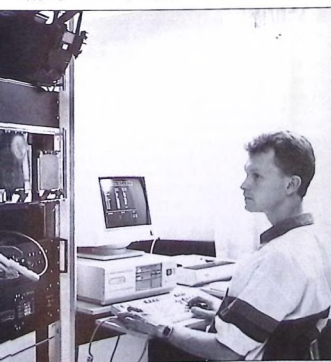
Joakim Stjernlöf gör utprovning på EP JA37 efter programändring i operativ programvara för elektroniks presentation.
