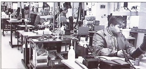
Mycket av arbetet inom Elektronikproduktion sker manuellt. Bland annat kretsckortmontering, apparat- och kablageinstallering. Verkstaden är ESD-skyddad och uppfyller kraven för renrum klass 3.
