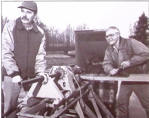
På provskjutbanan är Janne Carlsson och Stig Pettersson från Våpenteckstad i full färd med att ladda automatkanonen. Det är en 30 mm Akan till flygplan 35 som de avfyrrar för att mäta att bullernivån ligger inom tillåtna gränser.
