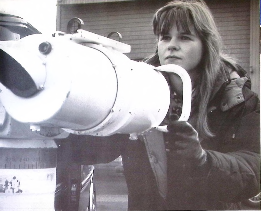
Torun Pahlén från Flygnavigeringsystem ställer in den TV-tracker som används vid flyginmätning på landningshjälpmedel som TILS, PN-55 och pejl. Trackern följer flygplanet under hela inflygningen och mätningarna görs för att kolla att flygförarna får riktiga data.
