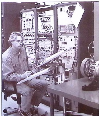
I konditioneringsutrustningen på Robotverkstaden provkör Johan Karlqvist en mätökare till robot 71. Med klimatanläggningen testar han både vibration som liknar flygplanens och temperaturer i intervallet -37 till +70 grader Celsius.
