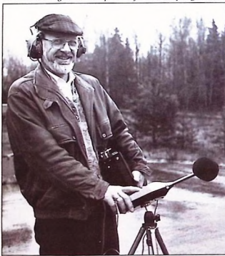
Här mäter Sven-Gunnar Persson, Kommunikation, bullernivåerna vid Åkan-skjutning på Robots provskjutbana.
