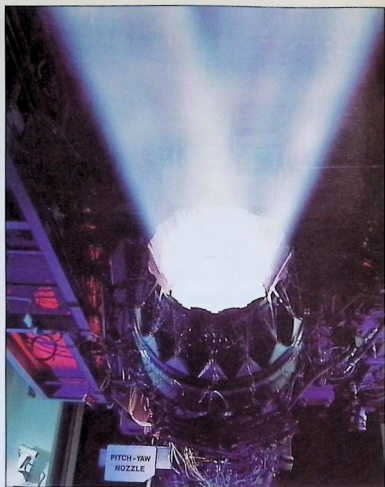
Pratt & Whitney PYBBN vektormunstycke. Bilden är tagen under två exponeringar med jetstrålen avlängd maximalt i två riktningar.
