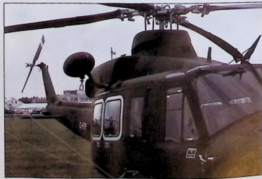
Installation av BL-20200 i helikopter AB-412.
