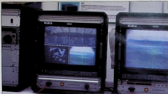
På bilden ser man fyra stycken videokällor som har spelats in och visas samtidigt på monitorn. Det är inte full videobandshastighet på alla kanalerna utan alla fyra måste dela på 25 Hz bilduppdatering.
