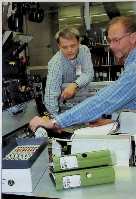
I JA37 testriggens förarplats finns anslutningar som ger tillgång till alla hjälputrustningar i flygplanssystemet. Här jobbar Dan Wetter och Lars Grindelid.
