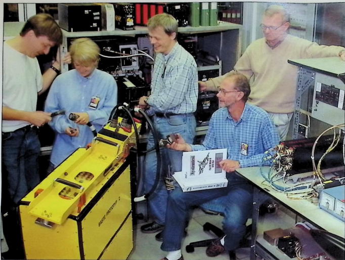
Här är de församlade i apparatrummet, själva hjärnan i testriggen, fr v Åke Krantz och Carina Larsson, NS, Dan Wetter, NST, Lars Grindelid, NS och Roger Thelenius NK. Gänget som gjort utprovning och verifiering av de nya systemtestfunktionerna. I förgrunden Baste, BalkAnsluten SingelTestEnhet, den nya utrustningen för systemtest av beväpningsinstallationen i både JA37 och JAS39.
