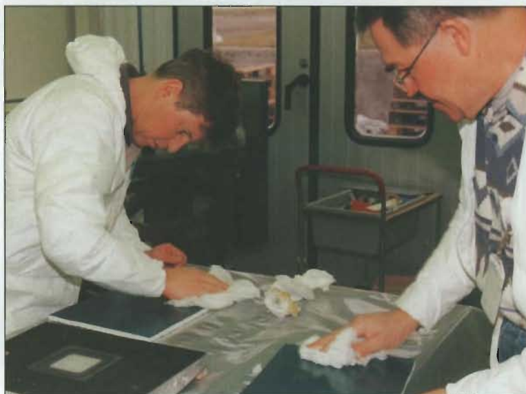
ACAB driver utbildning för flygvapnet inom reparationsteknik. Bilden visar när elever från F7 polerar gipsverktyg.
