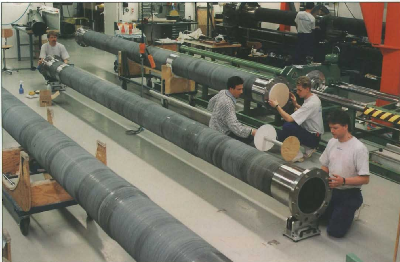
Bilden visar en interiör från ACABs verkstad. Det är montering av ändstycken till drivaxlar i kolfiber som pågår.
