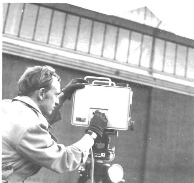
Lars-Ivan Lidén riktar värmekameran mot hangarportarnas överdel...
