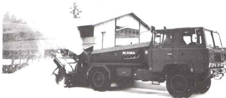
Saab-Scania-varianten visade sin förmåga att kasta 35 ton snö per minut.
