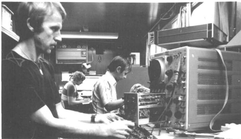
I en av våra teleservicebussar sitter fr v Karl-Gunnar Engman, Christer Lindberg och Anders Bergman och kalibrerar oscilloskop, frekvensräknare, signalgeneratorer, digitala multimetrar o d.
