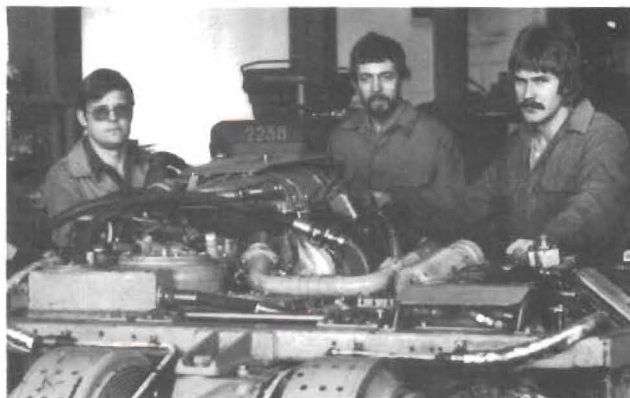
Från Jan Tapper, Lars Tykesson och Frank Gustafsson tittar upp bakom ett "motorpaket" till Strv 103 i förrådet, där de jobbar med underhållet på provvagnarna.
