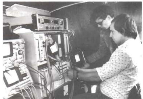
Sven-Håkan Nilsson (t h) kalibrerar datorn på plats i mätbussen medan Claes-Göran Danielsson kollar målföljningen på TV-trackern.
