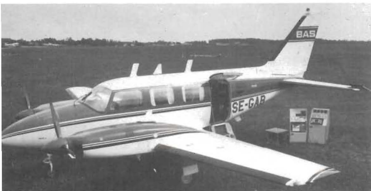
I flygplan typ Piper Navajo har vi installerat dels fast utrustning, dels de flyttbara mätborden och nav-radarn PN 59 som står till höger.
