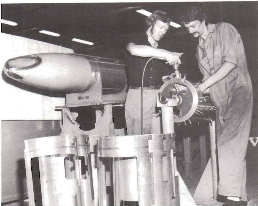
I plåtverkstaden vid CVM nitar Kenneth Andersson och Tommy Johansson ihop mellandelen till en FFV UNI-GUN POD, ett av utställningsobjekten vid flygutställningen i Farnborough i år. Många kundländer har hört sig för...
