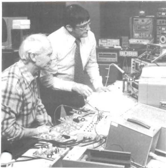
Alvar Söderholm och Alex Jonsson, 5630, arbetar med fjärrövervakningsutrustning LB 100, som används i flygplatsernas långvägsfyrrar. Alex och Jan Westman (ej med på bilden) har gjort jobbet på Karlskoga flygplats, som artikeln bl a handlar om.
