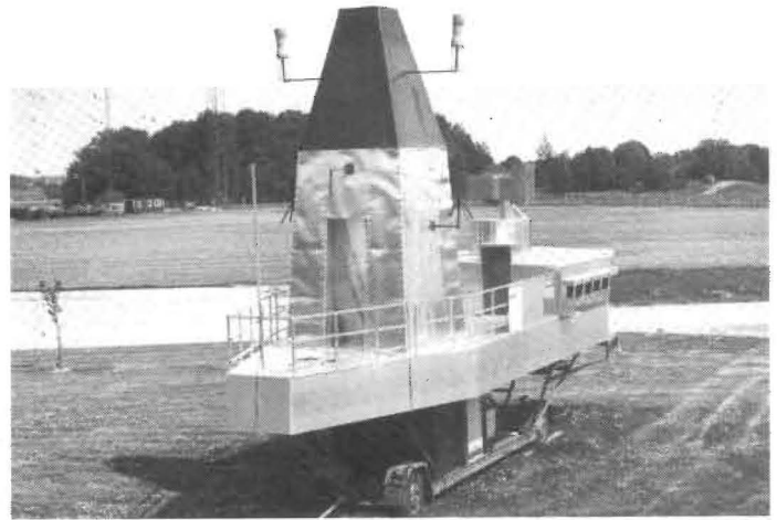
Denna skapelse är resultatet av sektion Antennmättekniks fantasi. "Antennkorvetten" K20 Arboga döptes högtidligen på flygfältet vid FFV Underhåll i Arboga i mitten av maj. Den har utnyttjats för mätningar på sambandsantennerna till kustkorvett 90, ett arbete som avslutades i september. Foto: Ingemar Kjellberg
