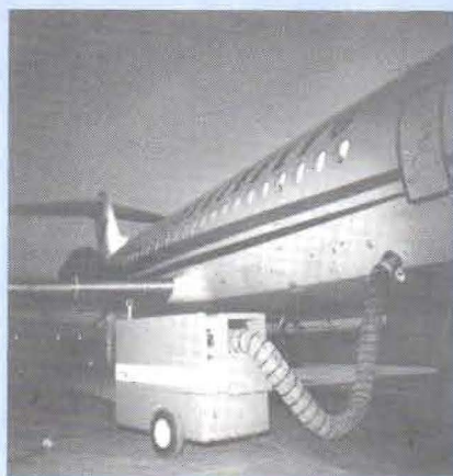
Så här ser den ut – den nya FFV-produkten AH-30, som ska värma eller kyla passagerarutrymmena i flygplan, allt efter behov med tanke på årstid och väder.
