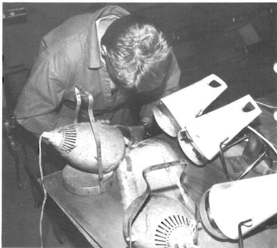
Limning vid reparation av plåtskador på vingroder eller flygplanskrov har blivit en allt vanligare metod, som avdelning Tillverkning använder sig av för att snabbt avhjälpa fel. Foto: Benny Aretun.
