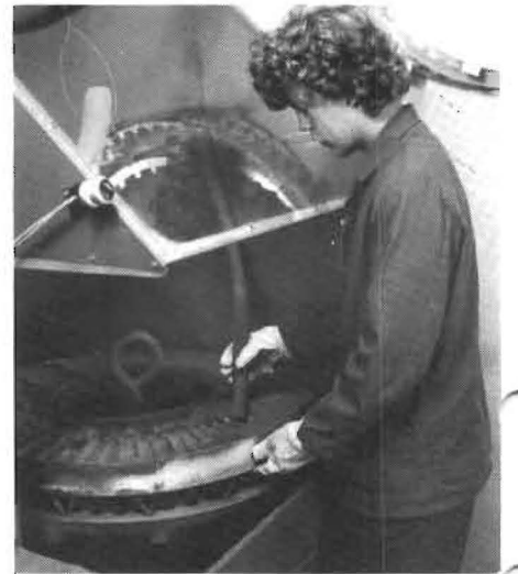
Åke Svensson har "packat" skovlar till RM8-turbiner i aluminiumpulver. Här suger han upp överflödet före upphettningen i värmugnen. Foto: Ingemar Kjellberg.
