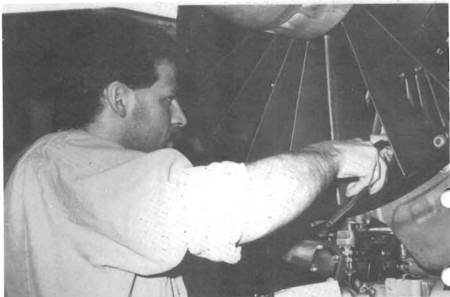
Michael Bäcklund, en av provarna på MP33, arbetar här med att lokalisera vibrationerna i en RM8-motor. Obalans är det dominerande problemet vid provkörning, men motorprovarna har själv hittat ett botemedel – så kallade clips. Det gäller bara att ta reda på exakt var de ska fästas för att trimbalanseringen ska bli effektiv. Foto: Anne Allard
