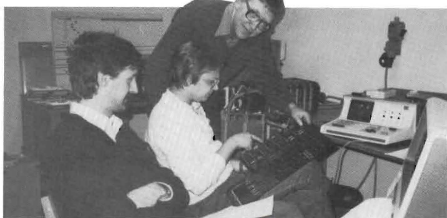
Sven Nilsson, i bakgrunden, är projektledare för modifieringen av datorn i flygplan J37 och visar här den funktionsmodell som Olle Hedberg och Tomas Sandkvist har konstruerat. Nu arbetar de med funktionsprov på modellen, som i prototypstadiet inte blir större än hörnet som vilar i Tomas famn. Foto: Anne Allard
