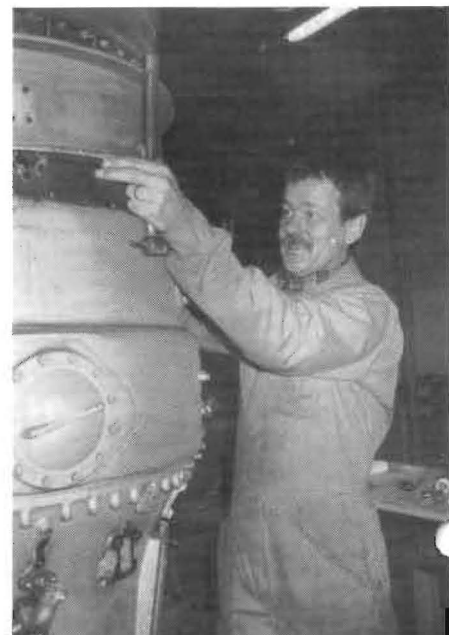
Sven-Åke Andersson, montör på avdelning Gasturbiner, demonterar en av Vattenfall Avonmotorer inför åtgärdsbestämningen.
