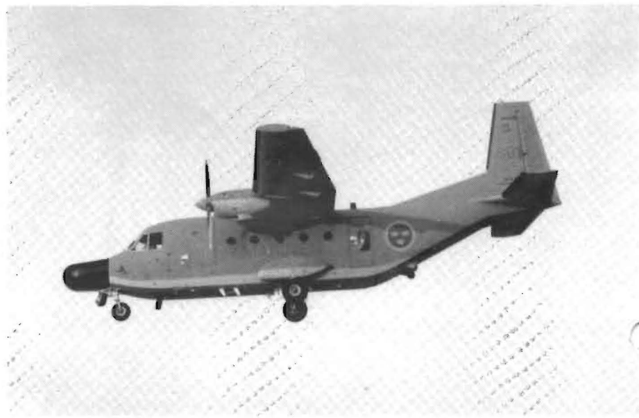
CASA 212 – eller som det heter inom marinen SH89 – är numera specialutrustat för att vara ett effektivt spaningshjälpmedel över våra svenska farvatten. Flygplanet kan operera upp till sju timmar i sträck utan tankning och har bra lågfartsegenskaper och kort landningssträcka.
