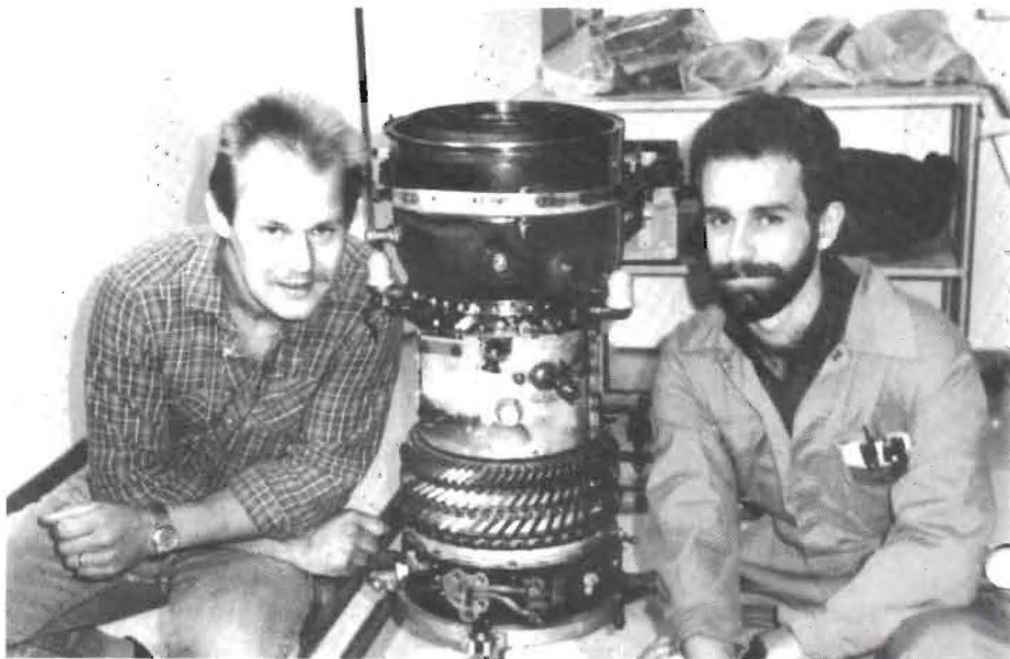
Här är helikoptermotorn TM2D, eller H1400-1 som den också heter, redan till hälften nedmonterad. I januari ska Torsten From tv som svarar för teknisk beredning och Anders Lundquist som sköter monteringsjobbet, vara klara att leverera motorn till LFK i Norge efter stor översy Foto: A Allard.
