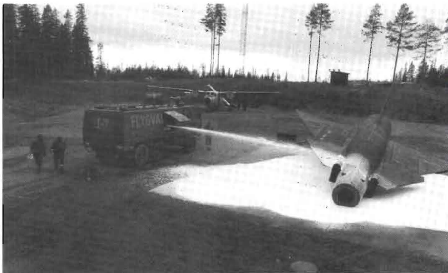
Fpl-attrapp 37 V gör det möjligt att arrangera fullt realistiska brandövningar för Flygvapnets Räddningstjänst.
