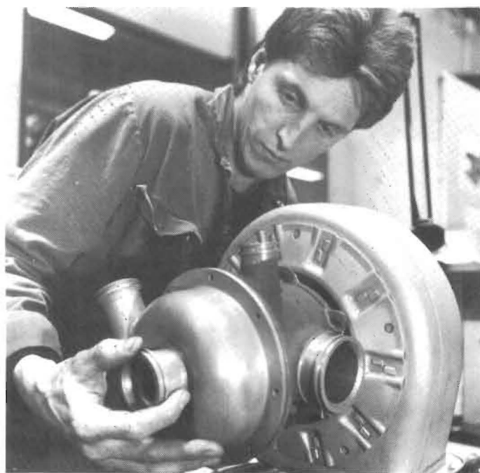
Peter Andersson vid avdelning Aviocomp monterar en luftfördelare, så kallad Air Cycle Machine, som reglerar lufttillförseln i kabinen på Saab SF340. Foto: Niklas Forslind
