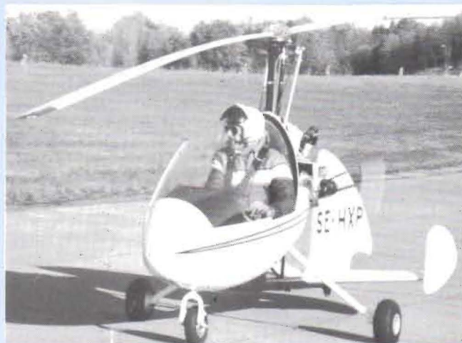
Det är ingen helikopter och inget vanligt flygplan heller – det kallas autogyro – "flygplan med rörlig vinge" – farkosten som Rune Larsson byggt.
