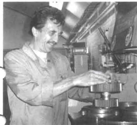
Oskar Hjalmarsson har liksom Berndt Andersson 18 års erfarenhet av läppning. Här läppar han ändytorna på ett cylindriskt kugghjul till RM8. (Foto: Anne Allard)
