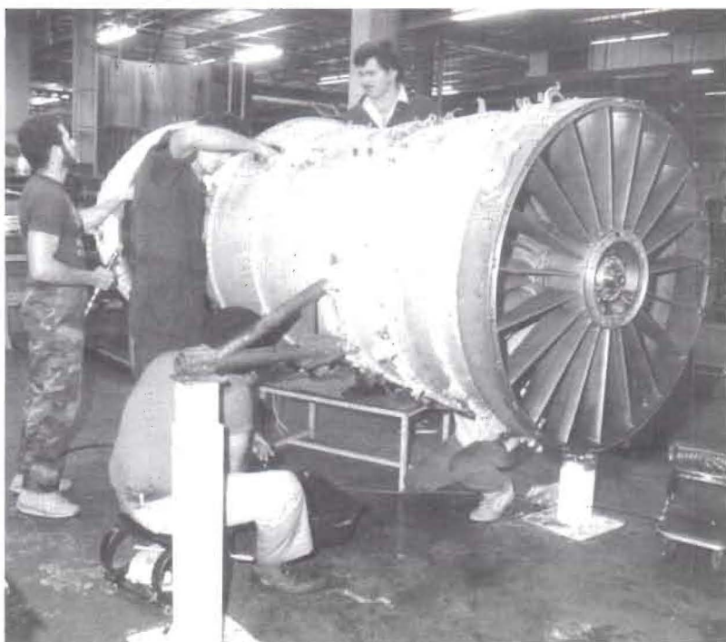
Här "kläs en motor av" och splittras i tusentals delar som alla får översyn eller byts ut innan motorn monteras ihop.
