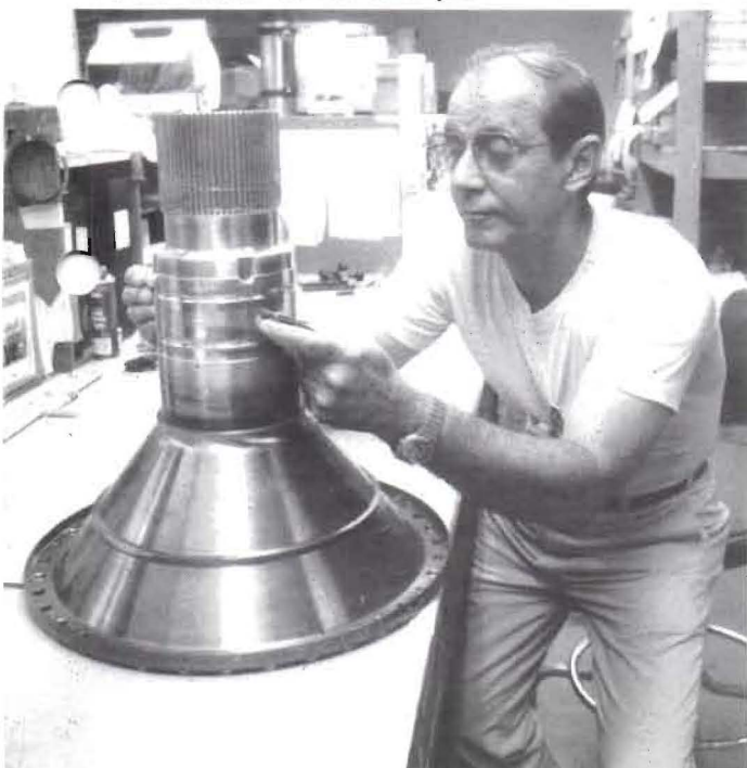
Motorns nav måste ha absolut exakt rätt dimension. Ramon Grum kollar med van blick måtten.
