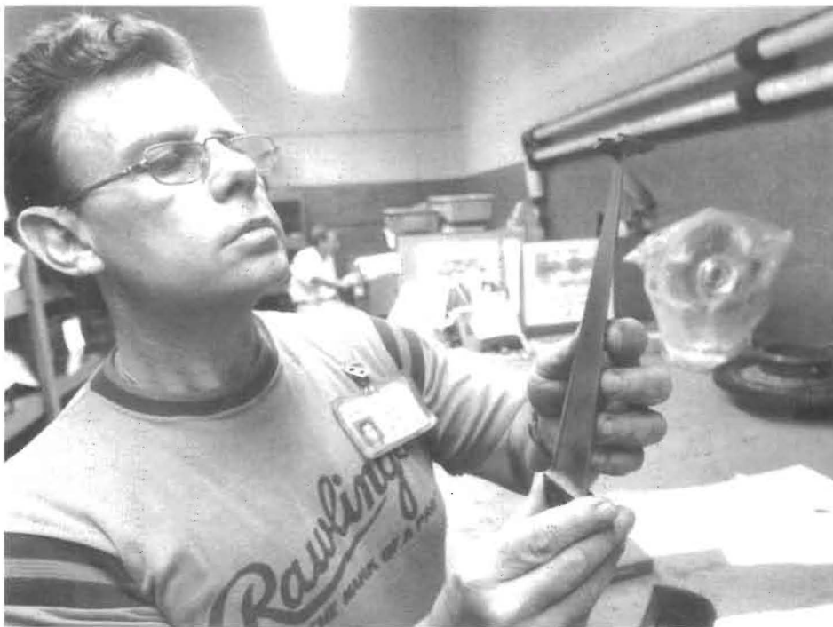
Willie Dillard synar en av de absolut viktigaste delarna i en modern jetmotor, skovelbladen i den heta delen av motorn. De måste vara absolut felfria för att klara kontrollen.
