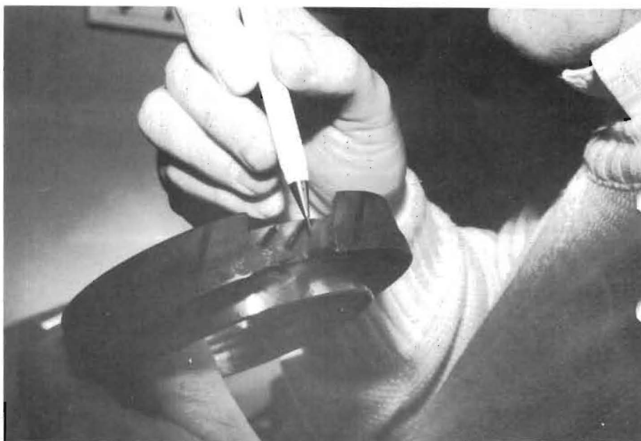
Sven Olof Thilenius visar på de sönderbrända segmenten. Nu slipas de skadade områdena bort och ersätts med nya segment.
