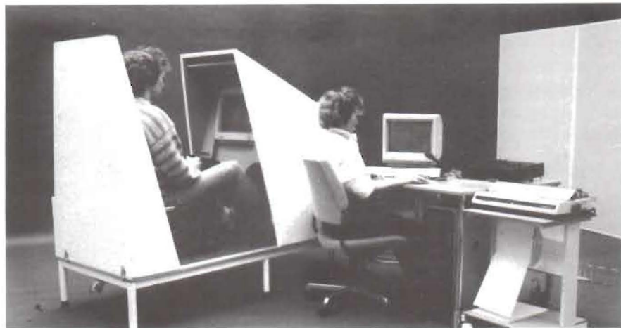
Monica demonstrerar testledarstationen i Scoop med dator, monitor och mixer till ljudsystemet plus skrivare. Hon håller ljudkontakt med eleven Stephan i cockpit via headset. Han manövrerar spak, pedaler och knappar och följer resultaten i sin monitor. En gaspedal på vänster hand är inte inkopplad, men tillhör de utvecklingsbara detaljerna.
