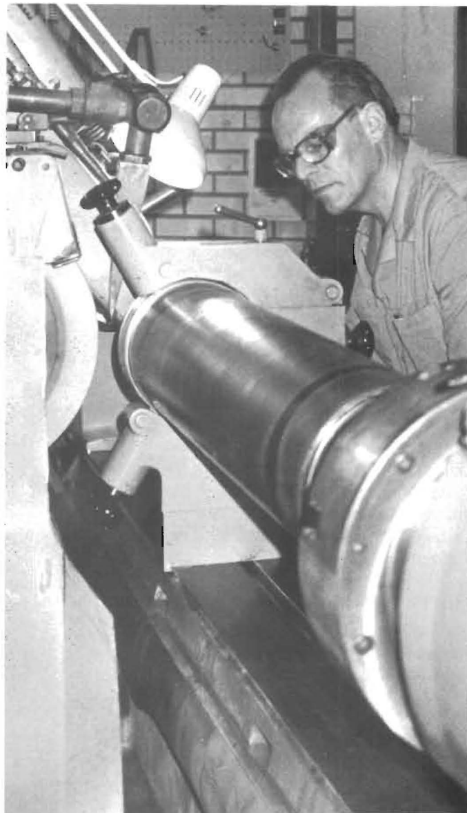
Olle Holm sätter upp en av motordetaljerna i sin maskin för att slippa ett plan. Det är en så kallad airduct från TeroNor som normalt sitter i kompressorn till gasturbinen LM2500.
