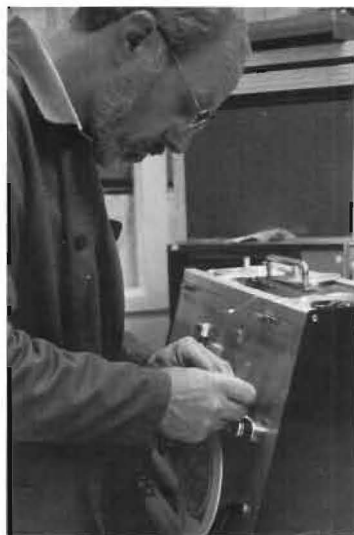
...fäster remsor av aluminiumfolie som indikerar var bandet vänder och byter kanal...
