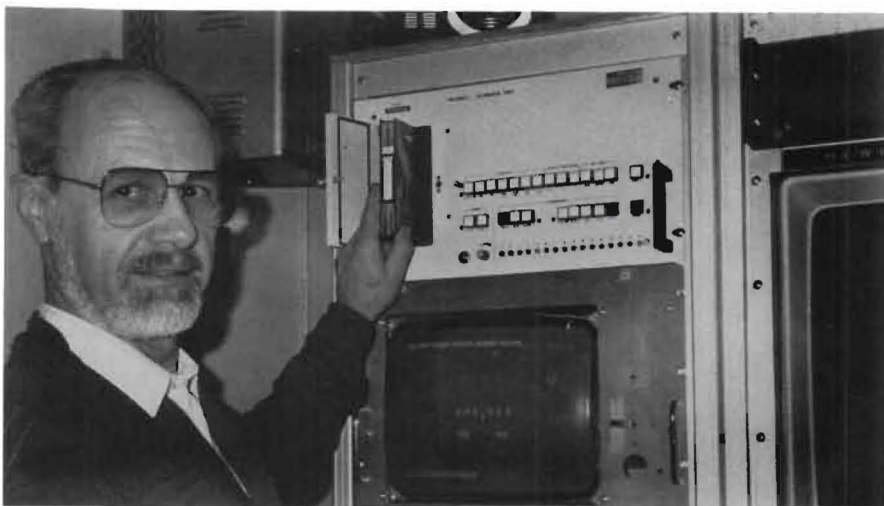
Här används banden, visar Sven-Gunnar Persson och stoppar in kassetten i UTB-bandspelaren. En utrustning för utbildningsregistrering där piloterna kan studera sina manövrar under flygpassen.
