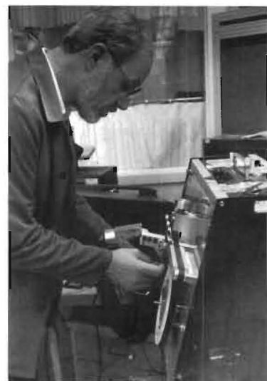
...startar spolmaskinen och mätaren registrerar snabbt och noggrant varje decimeter tills bandet är fullt...sid 24
