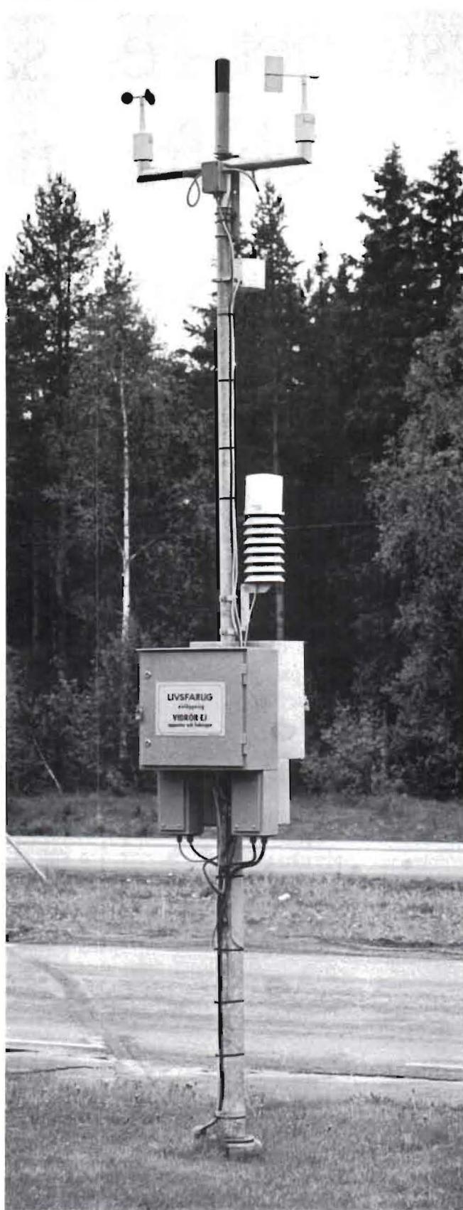
Så här ser det ut: mätstationerna till vägväderinformationssystemet. Över 500 sådana mätstationer finns längs de svenska vägarna
