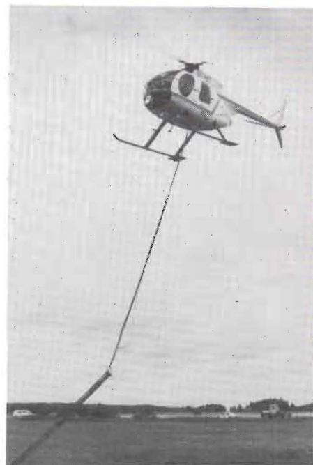
Uppe i luften hängde helikoptern en timme i taget, så att Antennmätteknik kunde göra sina strålningsdiagrammätningar på den 44 meter långa antennen. Foto: Ingemar Kjellberg.
