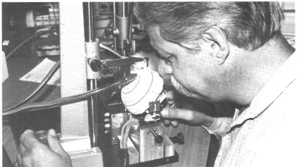
Modifieringen av flyglägesindikatorn i Viggens AJ- och JA-version kräver specialframtagen utrustning. Bertil Aronsson från avdelning Apparat arbetar här med grafisk målning – ett verkligt precisionsjobb! Foto: Benny Aretun.
