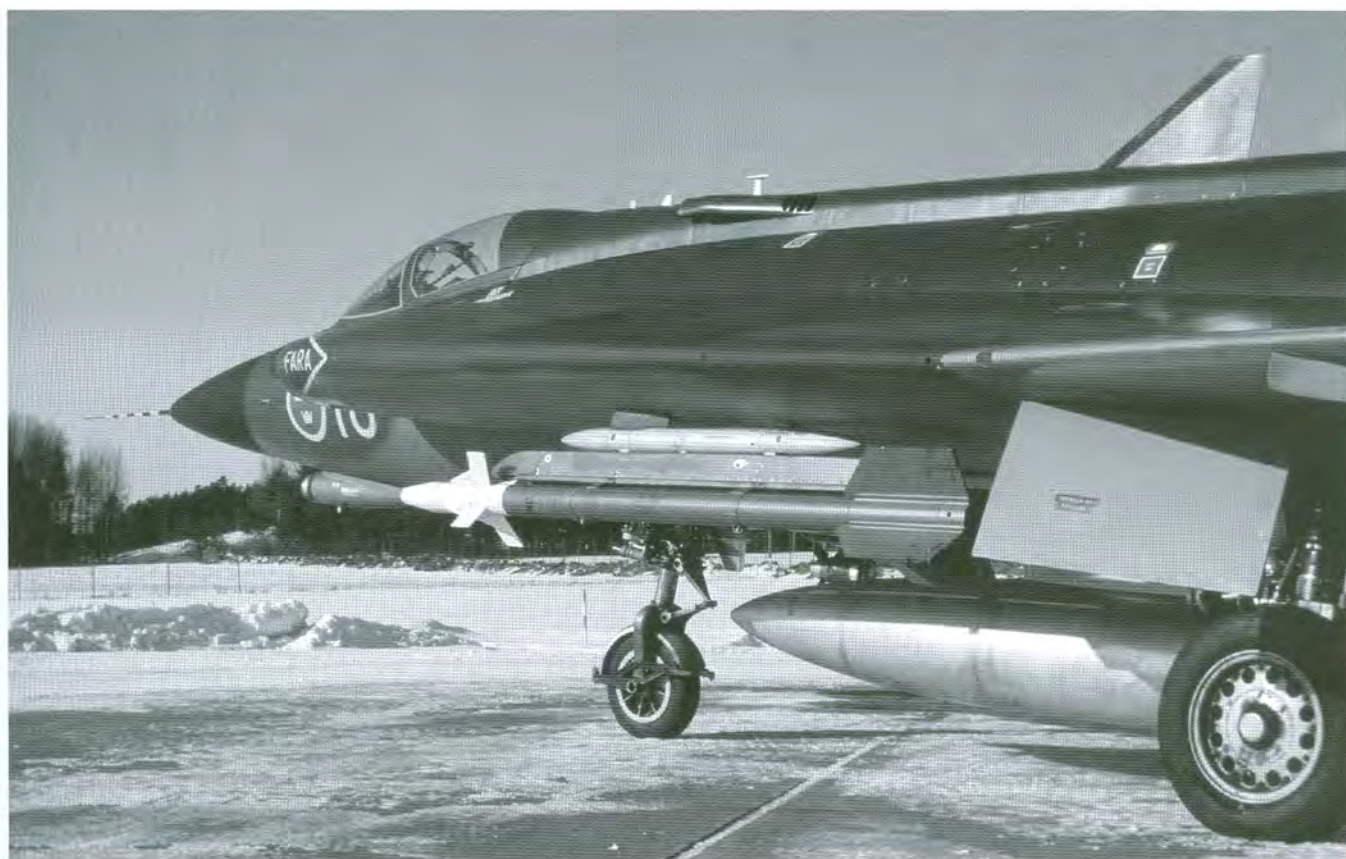
J35J med RB 24. Under nosen ses IR- sensorn. Foto: Saab.
