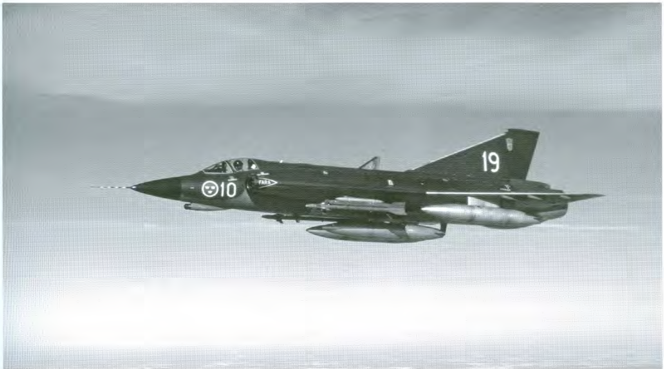
J 35J var modifierade J 35F med bl.a. fyra fälltankar. Foto: Saab.
