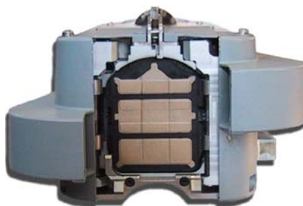
Bild 4:62. Remskapsel BOL 1. Tidigare var det vanligt med särskilda remspodar. Dessa tog då en vapenbalk på flygplanet. Remskapseln utgör här även själva vapenbalken och ett vapen kan hängas under remskapseln.
