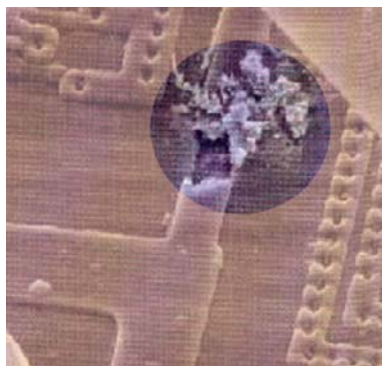
Bild 4:167. En svepelektronikmikroskop bild av skadad integrerad krets. Leda-rens bredd är ca 10 \mu\text{m} . Från "FOI orienterar om elektromagnetiska vapen och skydd (2001)".
