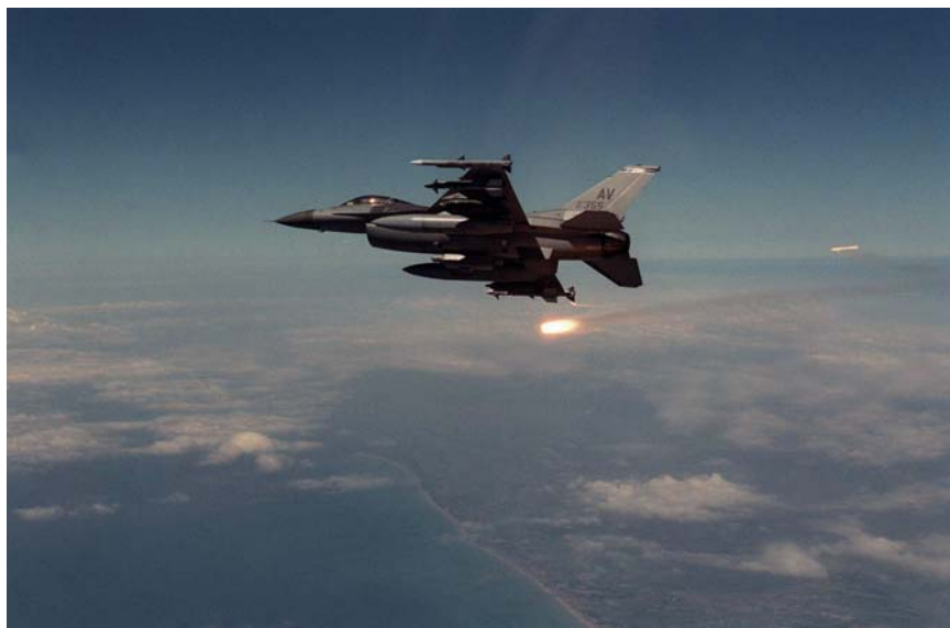
Bild 6:30. F-16 CJ utrustad med HARM och signalspaningsutrustningen HTS. HTS är kapseln under flygplanskroppens vänstra del. Normalt sett har flygplanet även störkapsel i den centrala kroppsbalken.
