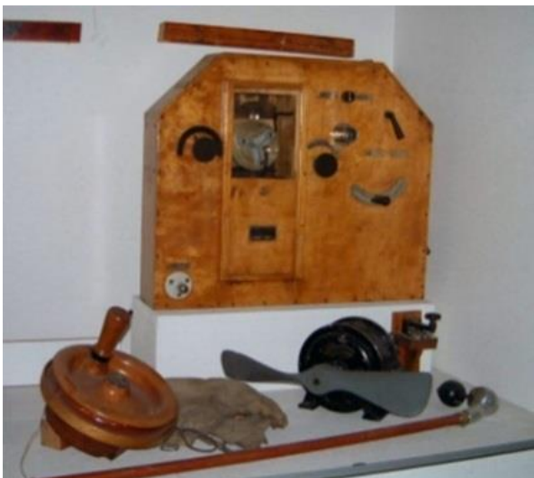
Flygradio Fr m/17 eller Fr m/ä med luft-propeller. (Foto Arne Larsson)
