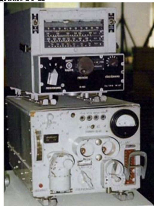
Flyradiostation Fr typ II Mottagare överst, sändare underst (Foto Arne Larsson)
