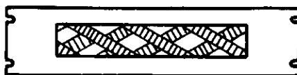
Bild 11.5 Styrorderindikator som utnyttjar perifer seendet. Två koncentriska glascylindrar är försedda med spiralband. Roterar cylindrarna åt samma håll uppstår ett intryck av rörelse uppåt eller nedåt. Roterar de åt olika håll erhålls ett intryck av rörelse åt vänster eller höger. Rörelsen kan uppfattas utan att piloten direkt betraktar indikatorn
